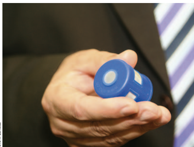
Sales Manager Thomas Lang von Elfo zeigt ein Musterteil mit fünf Siebelementen, die mittels drei Coils in die Spritzgießmaschine geführt, dort eingelegt, gestanzt und umspritzt werden
