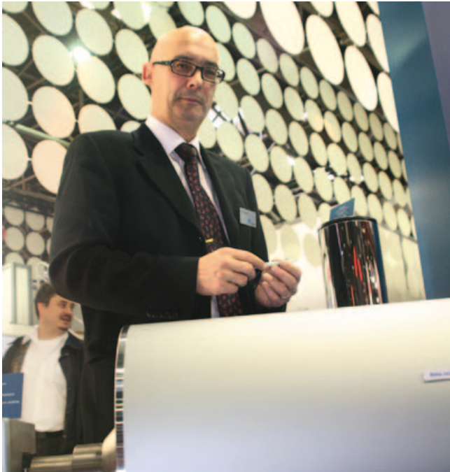
Bernhard Meier mit zwei Walzen für die Folienproduktion: Das besondere Firmen-Knowhow steckt in den Beschichtungen „spiegelhochglanzpoliert“ (rechts) und „elektrolytisch mattiert“ (vorne)
